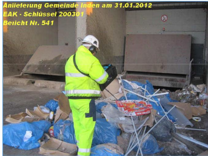
Figure 18 : Recherche du mercure dans les déchets avec AMS portable détectant les vapeurs de mercure –Communication personnelle de Lumex
