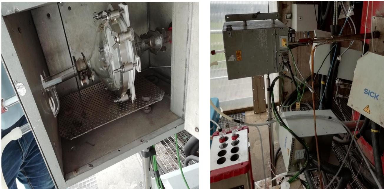
Figure 37: Usine C- Dispositif de prélèvement à la cheminée : (a) Filtre en boîtier calorifugé (avec dispositif en verre borosilicaté) et (b) Tubulure de connexion en PTFE et barboteurs refroidis –Adaptation de la *SRM*, Laboratoire CME
