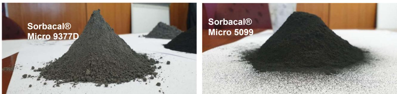
Figure 68: Test de coulabilité sur (a) le Sorbacal® Micro 9377D (CA 10) et (b) le Sorbacal® Micro 5099 (CA 25)
