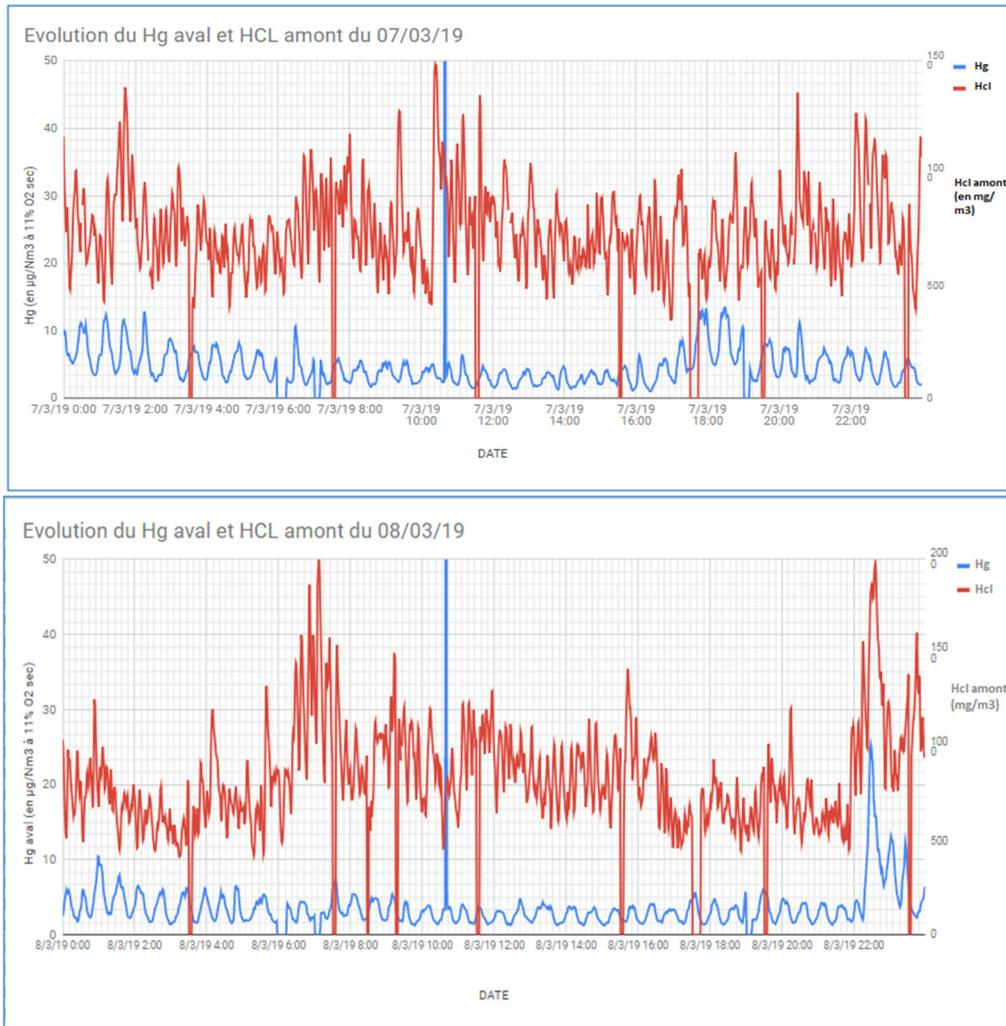
Figure 65: Oscillations du HCl en amont et du Hg en aval sur l'usine C le 7 et le 8/3/2019
